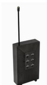
Dersom minst 2 stråler (1x under og 1x over) brytes, vil RG avgi et signal via radio til det sentrale "hovedkvarter"
